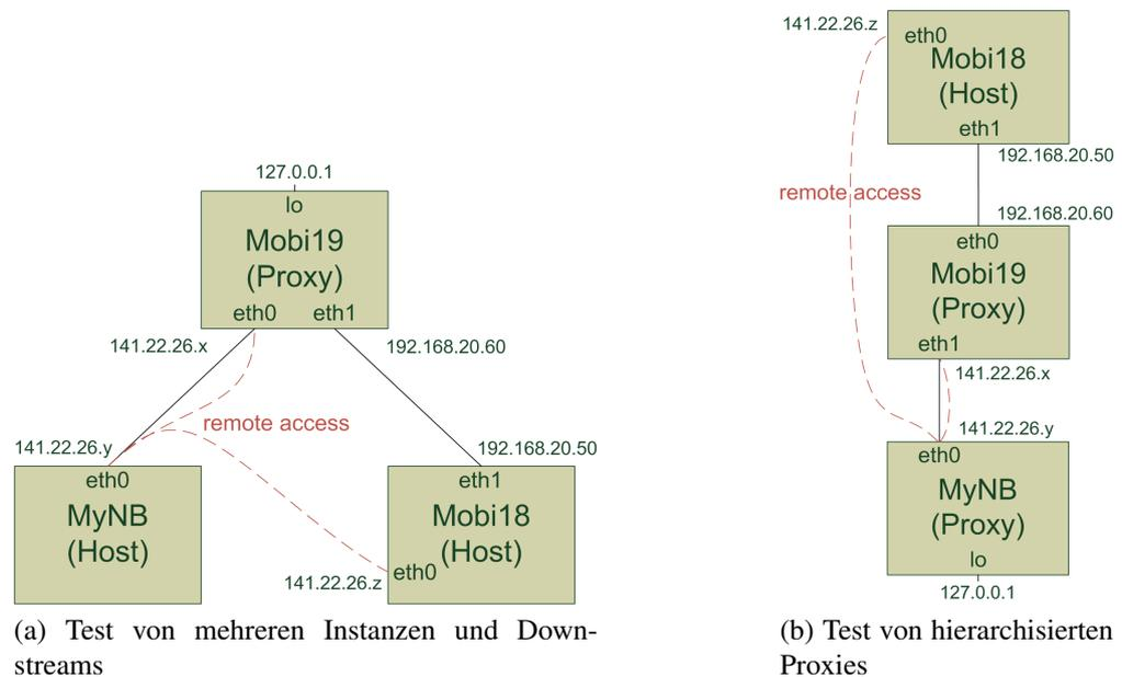
Abbildung 20: Testaufbauten zur Evaluierung des Multicast-Proxys
